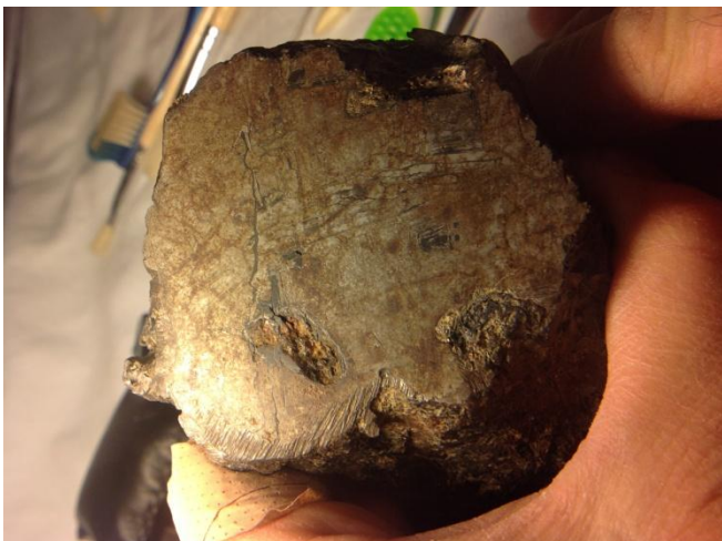
La pulizia comincia a dare le prime soddisfazioni. Si distinguono le figure di Widmanstätten che permisero, negli anni '50, di affermare che il sasso aveva origini extraterrestri.
